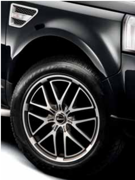
Leichtmetallfelge Design XA 9 x 20", ET 40 mm, LK 5/108 mm, Mittenlochdurchmesser 63,3 mm CW01903/GP graphit-poliert CW01903/AM anthrazit matt-finish
